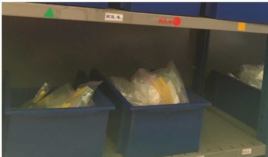
Gambar 4.13 Kondisi Aktual bin tidak memiliki identitas
