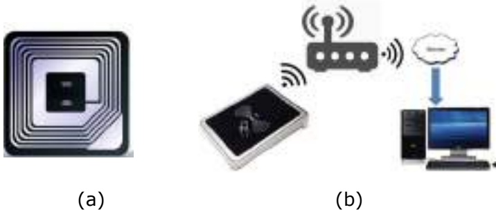
Gambar 1.16 RFID: (a) Tag dan (b) Reader
